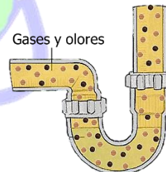
Sifas sin sello hidráulico, escape de malos olores.
